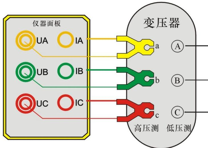
图 3、容量测试接线示意图
