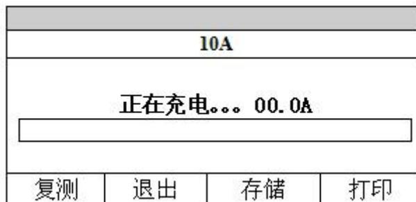
显示器中部显示区将出现一个充电进度条，进度条上部为当前的电流值，一般在测量大电感负载时，电流达到稳定需要一定时间，电流值由零向额定值上升。
