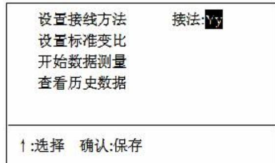
3. 接法设置, 进入接线方法设置后, 液晶屏显示如下
