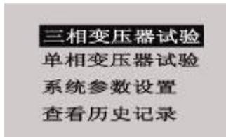
3. 通过“↑”、“↓”键选择三相变压器试验操作，按下“确认”键进入下一屏。
