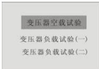
5. 选择“变压器负载试验”，按“确认”键开始试验，如图所示。（变压器负载试验一、二的选择参照以下计算公式。）
