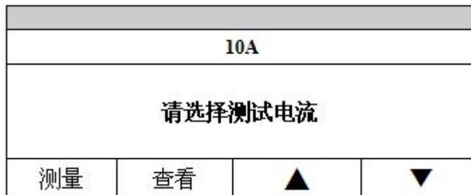
直阻仪提供了几种不同的测量电流，您可以根据需要按“▲”和“▼”键进行选择，请注意每种测量电流的最大测量范围，以免出现所测绕组直流电阻大于所选电流的最大测量范围，使测量开始后电流达不到预定值，导致直阻仪长时间处于等待状态（详细的技术参数请参见技术指标一节）。
