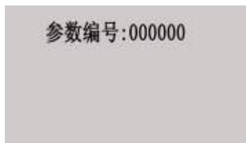
**参数设置方法：**按“确认”键移动数位，按“↑”或者“↓”键修改每个数位上的数字。参数编号中的前两位输入变压器型号（数字），后四位输入变压器容量。数字修改好后，按“确认”键进入下一屏。每次试验前必须把被测变压器的相应参数设置存储好，并调到当前参数里面，再进行试验，否则最后的试验结果就可能不正确（注意：参数未设置，试验无法进行）。
