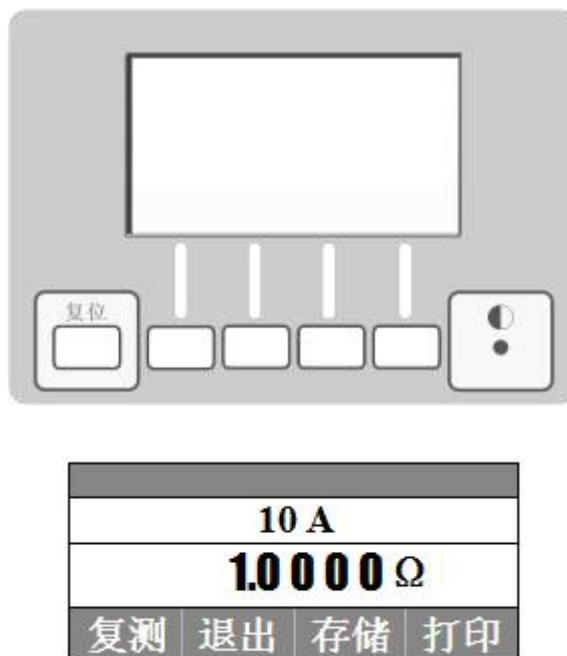
上图为液晶显示器和键盘组件组成的显示控制部分，其中显示器为点阵式液晶显示屏，用于显示操作提示、测量结果、以及指示显示屏下部 4 个多功能按钮的用途。左侧的“复位”键可使仪器在出现死机或从菜单退出时直接返回到初始状态。最右侧的小孔为显示器对比度调节孔，在显示器出现显示图形对比度过深或过浅，影响阅读效果时，可以用小型“一”字改锥进行适当调节。
