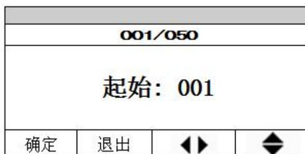
打印之前您需要设置需打印数据的起始序号和结束序号，使用“◀▶”键在序号的各位之间切换，使用“◆”键改变各位的数字大小，设置完成后按“确定”键确认。
