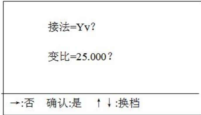
屏幕上显示的变比值是本次测量需要的实际标准变比值，按“↑”“↓”键可以修改此值。每次修改的幅度=设置的标准变比×调压比。测量完成后，显示如下
