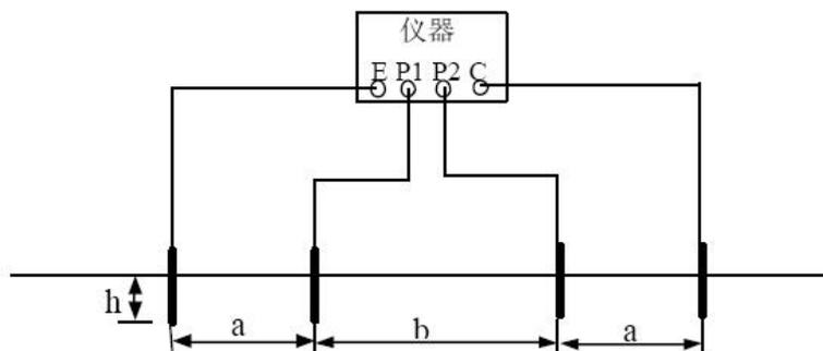
图7 四极法测量土壤电阻率接线图
