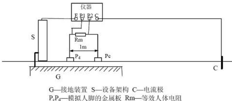
图6 跨步电压测量接线图
