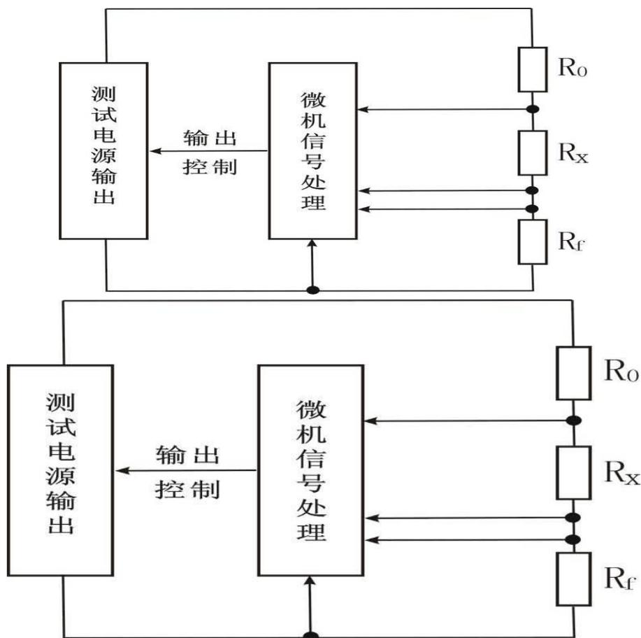
图 1 测量原理示意图
