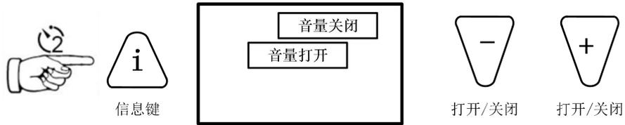
按动一次按键“i”，屏幕上将显示音量“Volume”菜单，按动按键“+”/“-”打开/关闭蜂鸣器。
