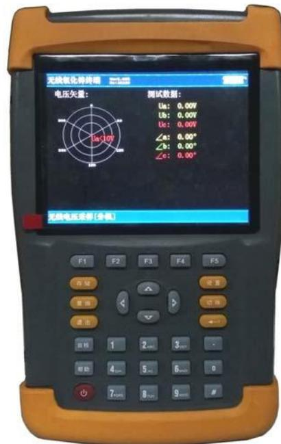
图三、电压无线测量终端
