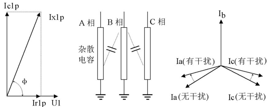
现场测量时，一字排列的避雷器，中间 B 相通过杂散电容对 A、C 泄漏电流产生影响：A 相 φ 减小 2° 左右，阻性电流增大；C 相 φ 增大 2° 左右，阻性电流减小甚至为负；B 相基本不变，这种现象称相间干扰。对相间干扰一种方式采用自动补偿方式，这种方式是以 B 相对 A/C 相的相间干扰对称为前提进行的，现场情况复杂，不建议用自动补偿，建议用分析原始测量数据趋势进行判断。可参考下述方法对 MOA 性能判断：
