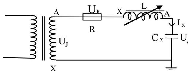
图 1 串联谐振回路原理图
