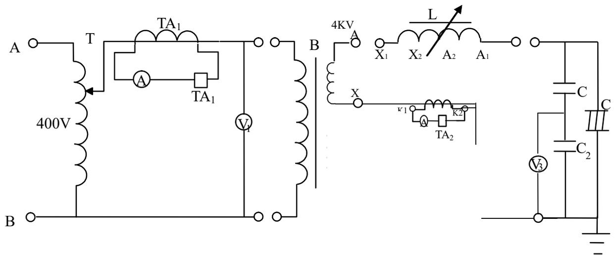
图 7 串联谐振试验原理接线图
