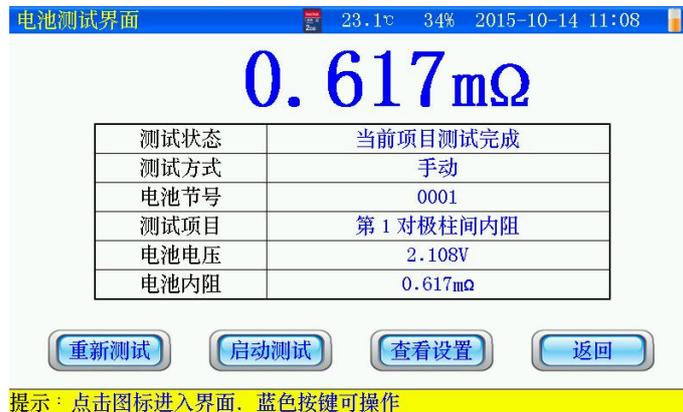
图 3.3.1-2 2 个以上极柱同时测量电压和内阻界面
