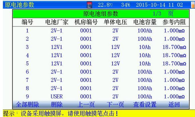
图 3.2.2 原电池参数设置界面
