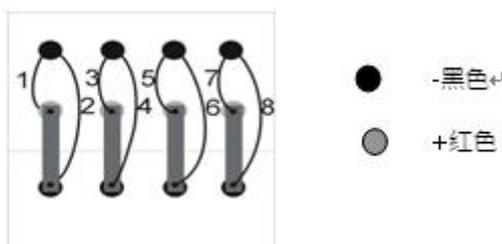
图 2.2.2-2 测试电池极柱和连接条的顺序
