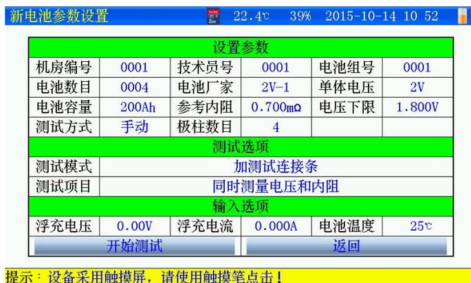
图 3.2.1-1 新电池参数设置界面
