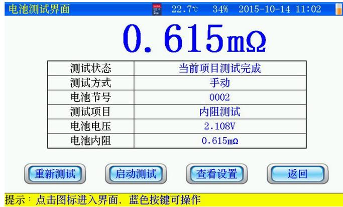
图 3.3.1 在极柱上同时测量电压和内阻测试界面
