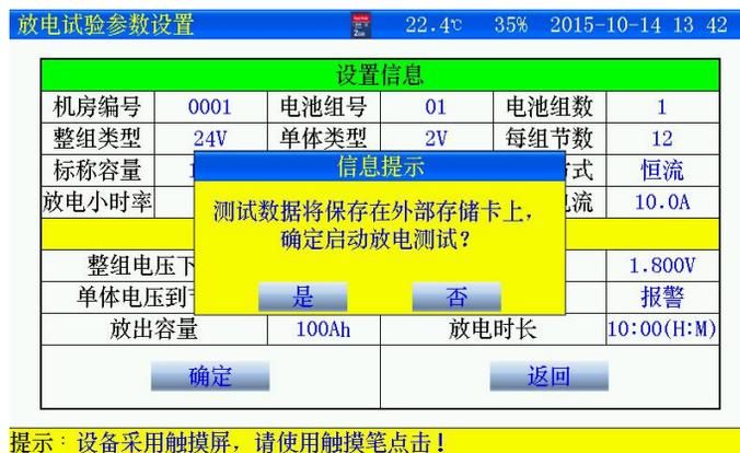
图 3.2.2-1 确定启动放电测试界面
