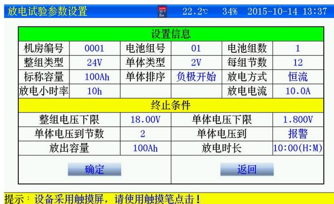
图 3.2.2 放电参数设置界面
