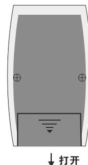
1. 更换电池前, 必须将钳夹移离被检导线, 不要在测试中更换电池。
