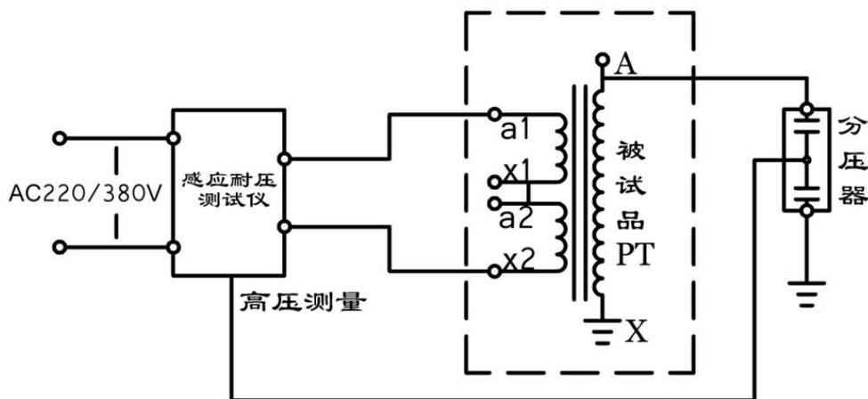
二次绕组串联加压原理图（附图二）
