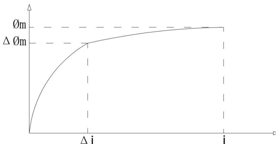
图 1 激励电流与主磁通振幅的关系
