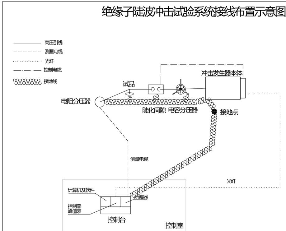
适用试品：陶瓷单片绝缘子、玻璃单片绝缘子
