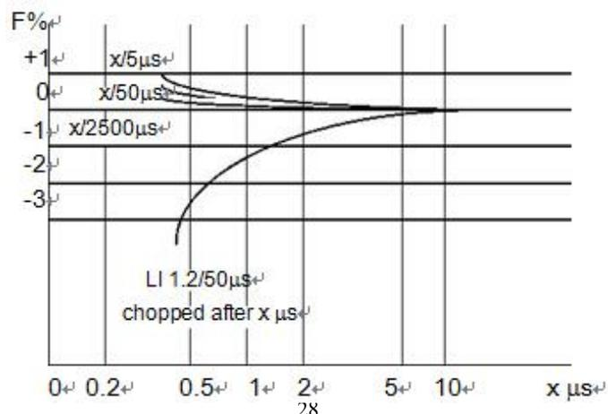
测量结果是在低电压下获得的。然而在高压试验室的多次核对试验中，除截波外都能得出同一结果。
