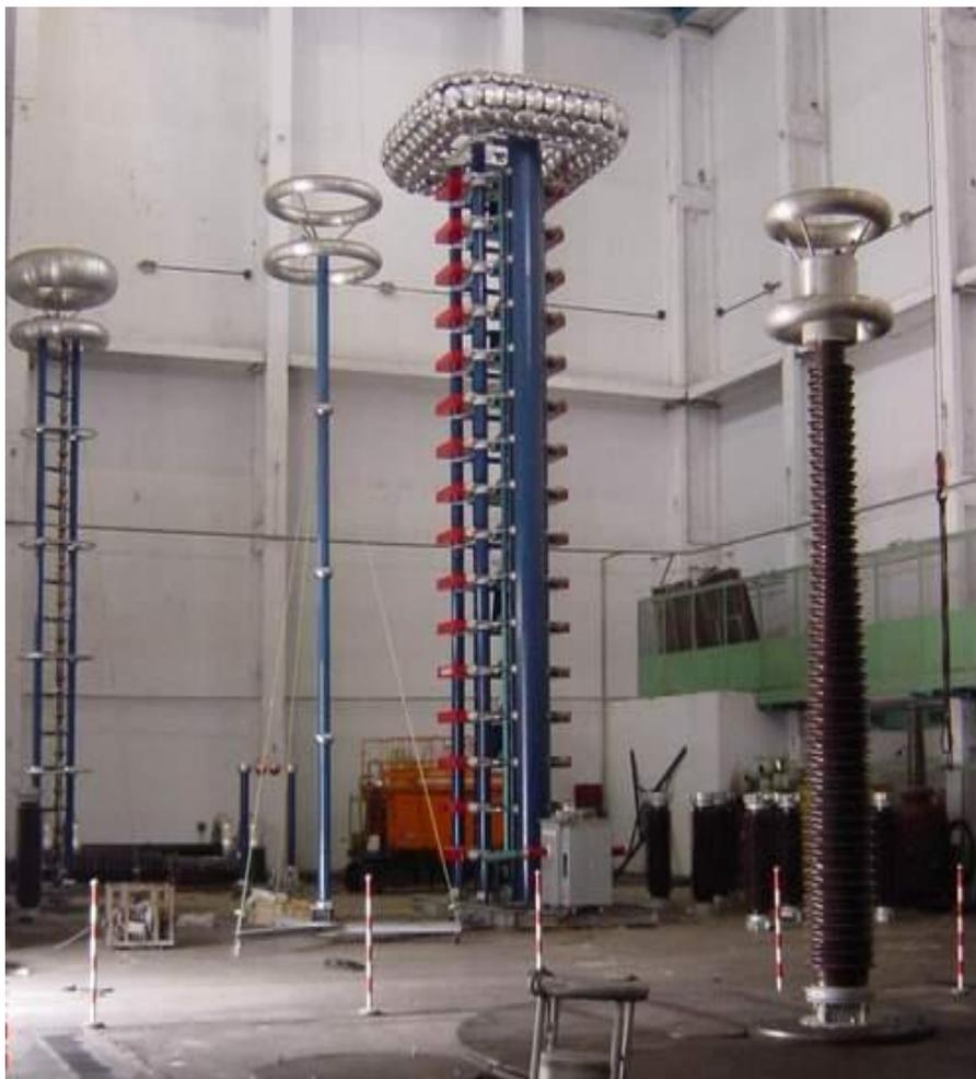
图 3 3200kV 冲击电压试验系统
