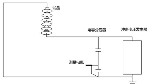
3) 绝缘子陡波冲击电压试验的设备布局及接线说明：
