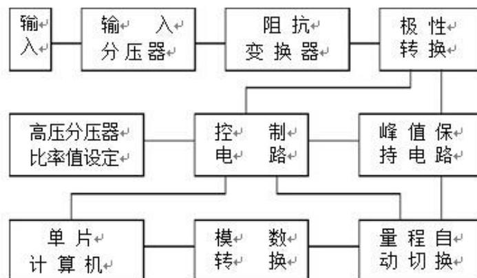
用量程自动切换电路可将峰值保持值放大到超过 A/D 转换器满量程的一半, 以保证 A/D 转换精度。在“高压分压器比率乘法器”中, 测量信号的峰值是乘以高压分压器的比率。亦考虑了输入衰减器的系数。
