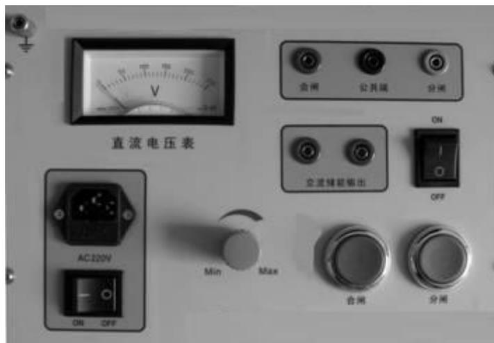
※ 为安全起见，建议输出接合分闸线圈时，将辅助触点串接进去。
